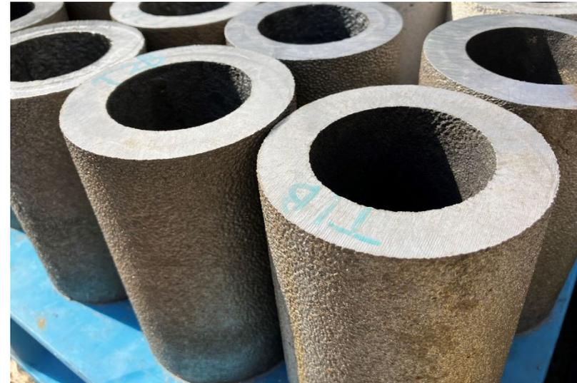
アンモニア分解プロセス特化材 試作鑄造サンプルの写真
